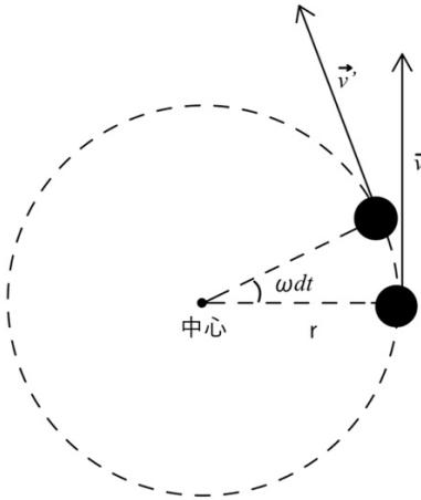
物体の速度ベクトルは物体の経路の接線方向を向くから、円運動する物体の速度ベクトルは必ず円の接線方向を向く。物体の速さ $v$ [m/s]をとすると時間 $\Delta t$ [s]の間に物体は $v\Delta t$ [m]だけ移動し、中心角は $\omega\Delta t$ 変化するから、
