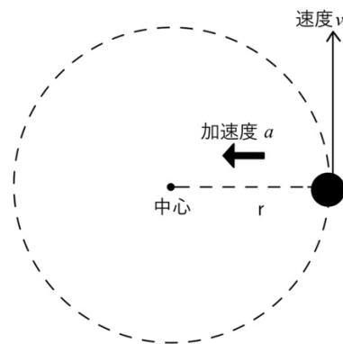
円運動をする物体は加速度を持つが、このことから円運動をする物体には必ず力が作用しているなければならない。物体にはさまざまな力が作用しているが、この力を接線方向と動径方向に成分分解したときに、動径方向に作用している力(の成分)のことを向心力という。等
