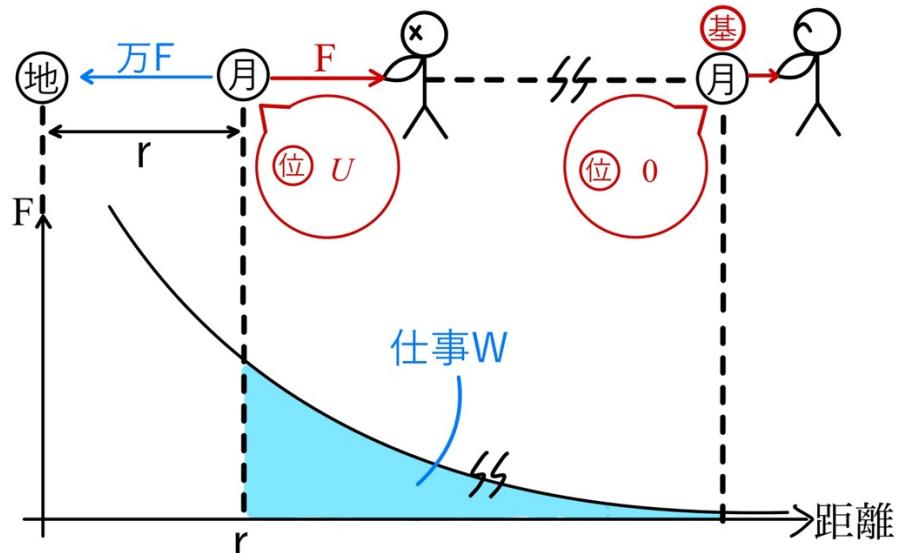
質量 $M[\text{kg}]$ の地球が図のように固定されており、これから距離 $r[\text{m}]$ の位置に質量 $m[\text{kg}]$ の月があるとする。図のように軸を設定し、この物体を無限の彼方まで動かすときに万有引力のする仕事を計算する。
