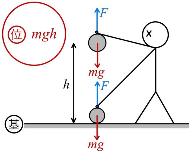
上の図のような場合について考える。人が質量 $m[\text{kg}]$ の物体を持ち上げるのに必要な力は $F = mg$ である。
