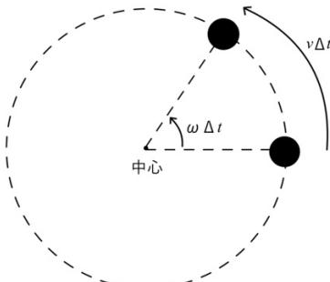
円運動する物体と円の中心を結ぶ線分(動径)が単位時間(1秒間)に掃く中心角を**角速度**  $\omega[\text{rad/s}]$ という。角速度が一定値であるとき物体の回転する速さは一定値となるので、このような円運動を**等速円運動**と呼ぶ。角速度が  $\omega[\text{rad/s}]$  の等速円運動において、時間  $\Delta t[\text{s}]$  の間に物体が回転する角度は、
